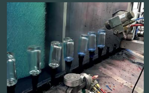
Installation à broches rotatives
