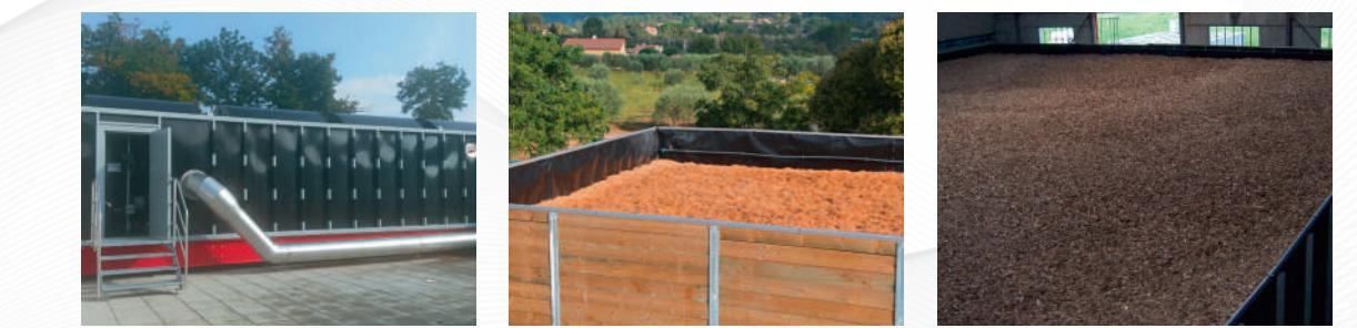
La nature de la biomasse peut varier en fonction du type de polluant à traiter. On peut ainsi employer de l'écorce de différentes essences de bois « hachées en copeaux de différentes tailles », ou de la fibre de coco, voir, de la tourbe fibreuse.
