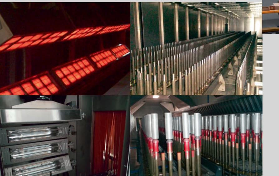
Des fours et des tunnels de séchage ou de cuisson polymérisation :
