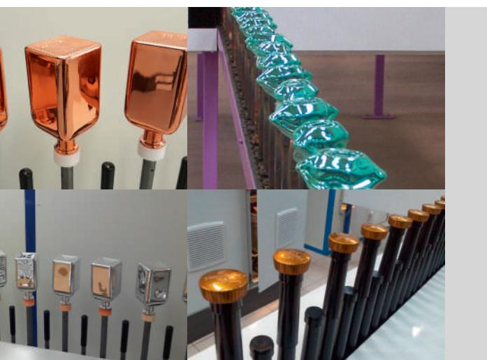
Conception de nouveaux modules de métallisation et de séchage, issus des technologies de métallisations liquides. Maîtrise d'œuvre de l'intégration du matériel de métallisation liquide en ligne et de traitement des effluents. Ces modules sont intégrés dans vos projets d'installations de laquage ou ajoutés à vos lignes existantes.
